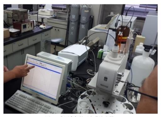
圖 6:水泥中氯離子自動滴定儀
