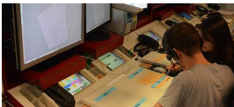
圖 33 有管制條模擬機 (ELECTRA) (來源：ENAC 網頁)
