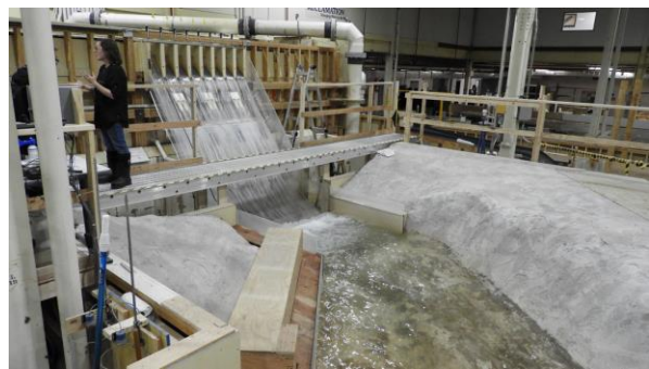
圖 26. Shasta 壩水工模型(比例 1:60)
