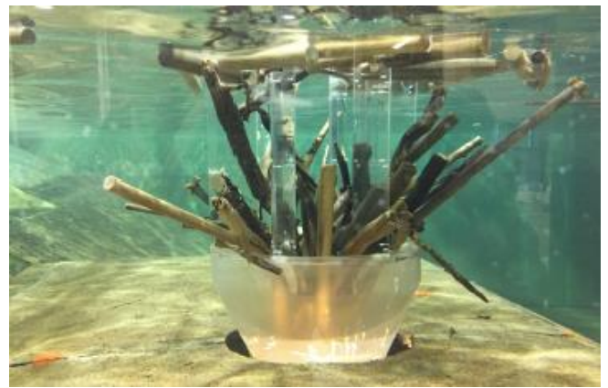
圖 36. 喇叭口溢流道水工模型試驗。
