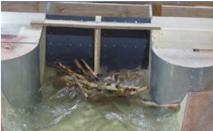
圖 35. 閘門開度與漂流木水工模型
