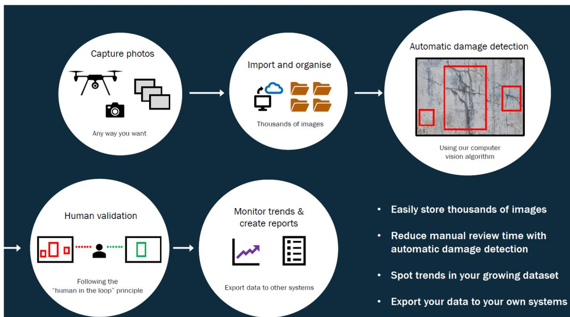
圖 32 無人機進行橋梁檢測之作業流程
