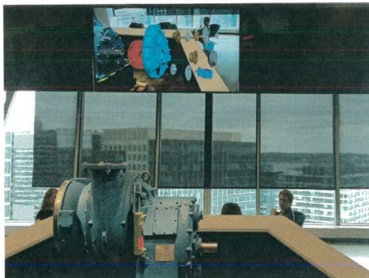
電動機內的軸件以虛擬的方式分解並呈現在 AR 畫面中
