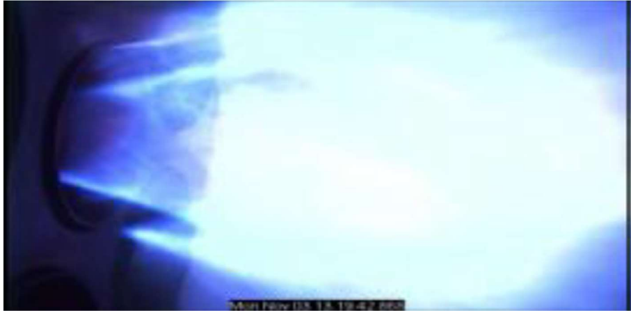
圖53 GE公司7HA型氣渦輪機燃燒器測試火焰照片
