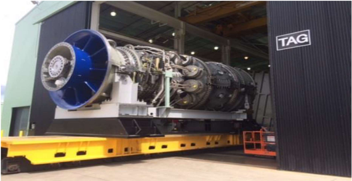
圖58 GE公司7HA.02型氣渦輪機進入FSFL驗證測試工廠
