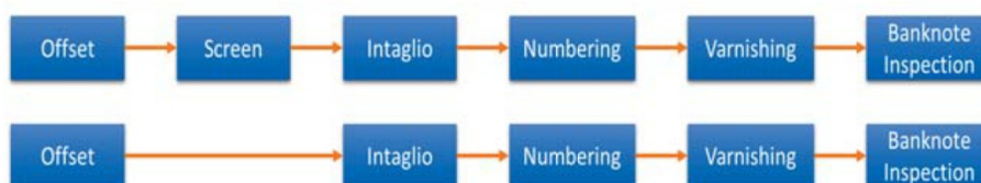
圖 4-3-1 墨西哥印鈔廠原生產線配置 (資料來源： 2019 Intergraf Copenhagen proceedings)
