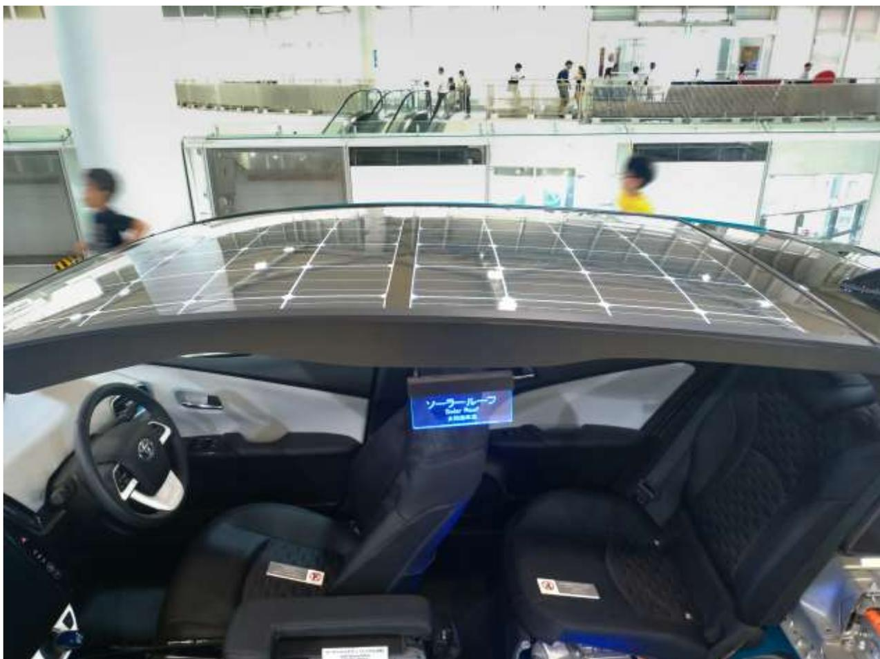
圖 06、屋頂搭載薄型太陽能板提供部分車用電力來源。
