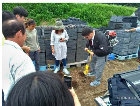
圖21. 右上為長倉良守社長親自示範，再由團員輪流示操作，可分三段式輕輕踩下去就可在 1 分鐘內鑽出所需的洞徑，全機組相當地輕，連女生都可以輕鬆操作，目前國內尚未引進。
