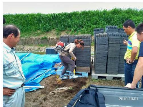
圖21. 右上為長倉良守社長親自示範，再由團員輪流示操作，可分三段式輕輕踩下去就可在 1 分鐘內鑽出所需的洞徑，全機組相當地輕，連女生都可以輕鬆操作，目前國內尚未引進。
