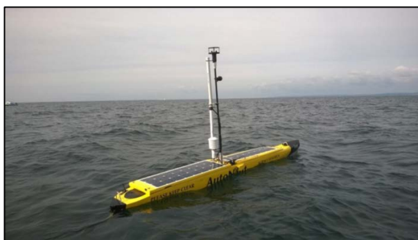
圖 4.10 於無人船之 Gill 超音波風速計
