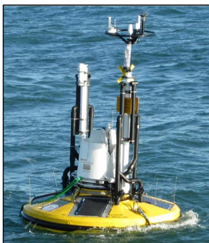
圖 4.8 漂流浮標上之 Gill 風速計
