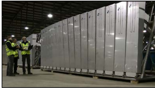
圖 5.7 造波機造浪設備
