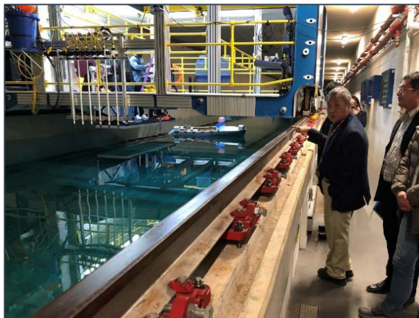
圖 2.19 測試中之船模試驗水槽
