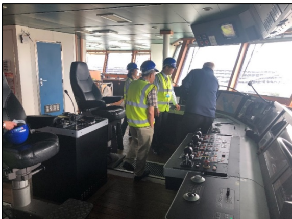
圖 3.30 駕駛台電子航儀設備與操縱系統
