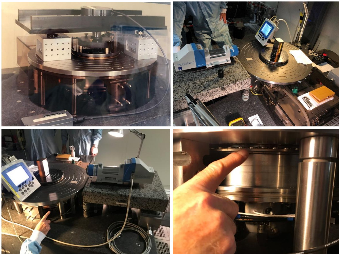
照片 9 環形編碼器、方規、自動視準儀校正系統
