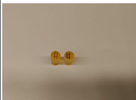
圖三十三、薄膜樣本轉貼附至圓柱形樹脂載台
