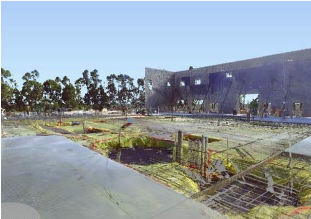
圖表 27 捕捉成為點雲數據（來源：FARO 官網）
