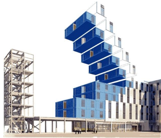
圖表 42 客房箱體工法示意圖（來源：CIMC 官網）
