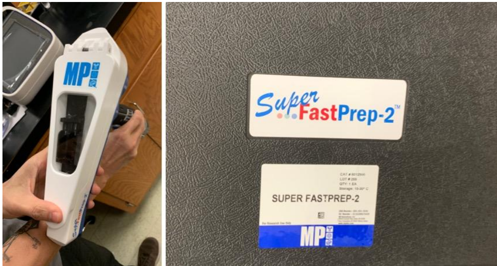
圖 27、萃取 DNA 所使用的手持式破菌設備
