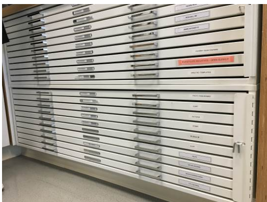
抽屜櫃內設計較低的抽屜，可增加抽屜層數，存放大量經分類的文保材料，抽屜兩側另有防震用卡樺，避免抽屜滑出。
