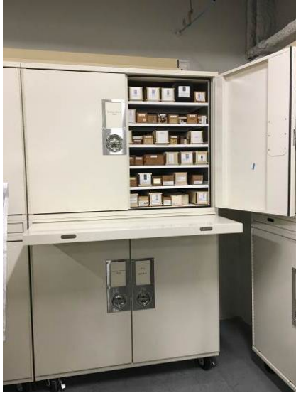
為防震目的，櫃架皆設計加裝門板，且設計有暫時性展示平台（櫃架中央處）
