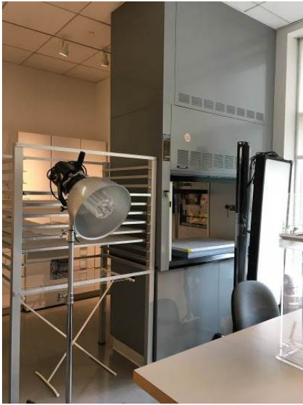
雙向開放的抽氣櫃設計，可方便修護師多角度利用設備執行修護。
