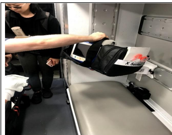
救護車內心電圖機可拆卸式移動支架
