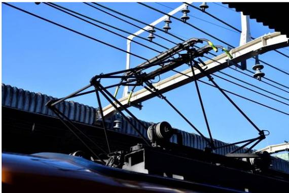
圖 114 近鐵車輛集電弓設計，集電舟不使用碳刷
