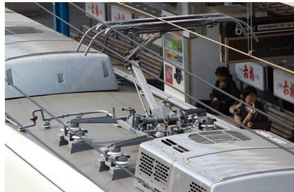
圖 115 「觀光特急 Shimakaze」集電弓設計，集電舟為合金鋼
