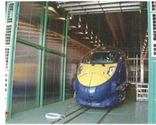
●構体気密疲労試験設備
