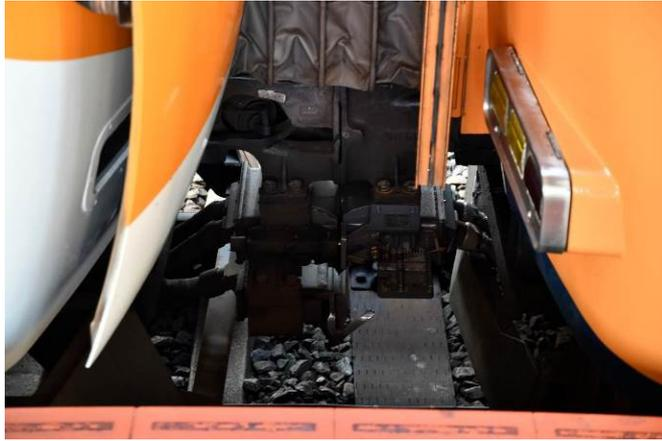
圖 113 近鐵車輛使用的全自動連結器
