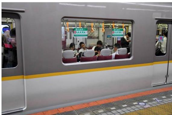
圖 117 近鐵通勤車輛使用高椅背座椅並有頭枕設計
