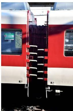
圖 116 近鐵車輛使用的防墜裝置設計
