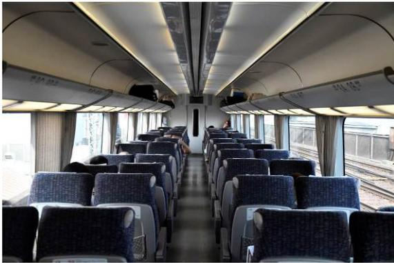
圖 118 近鐵 21000 型電聯車內部，於行李架下方設有日光燈以避免座位過於昏暗
