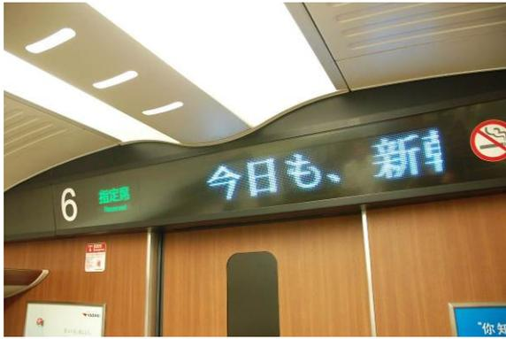
圖 121 新幹線電聯車車內之車廂號碼顯示不使用 LED
