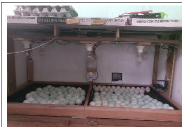
圖.卡拉旺地區核心鴨農自製簡易型孵化機
