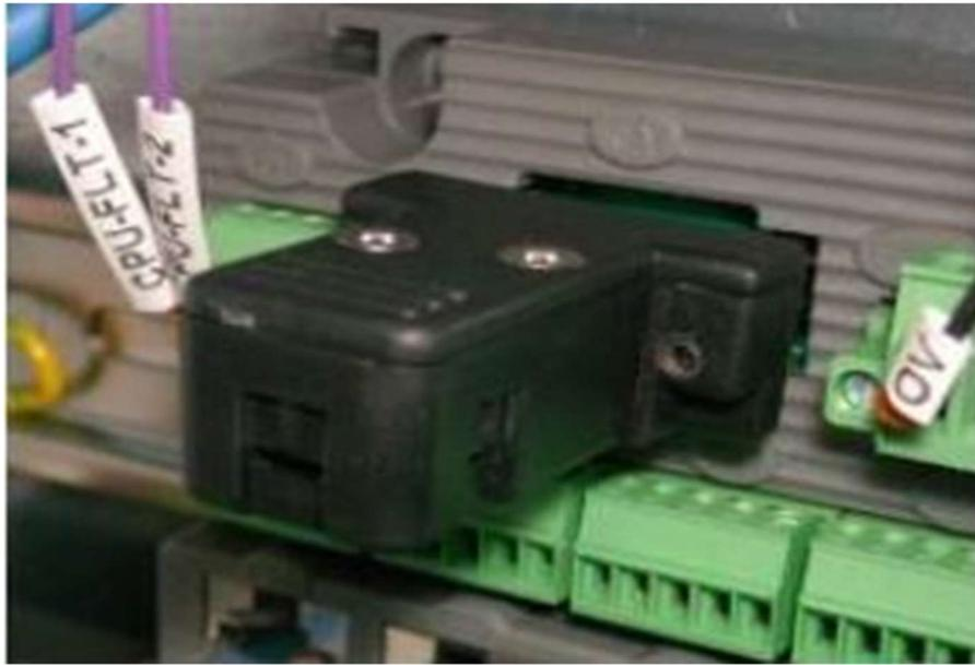
圖 27. AADvance 系統控制器底板加密勾(Dongle)實體圖
