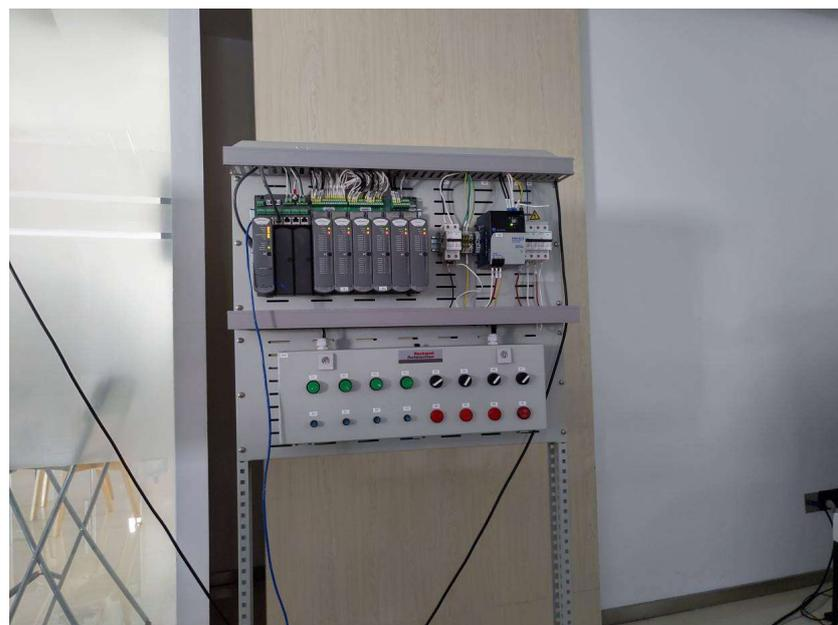
圖 24. AADvance 系統硬體安裝練習實作圖
