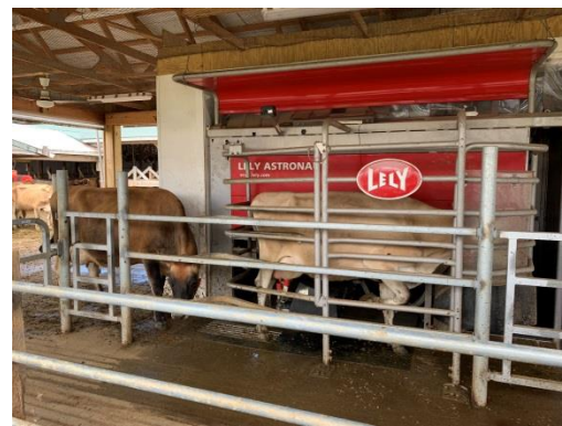
圖 22. St. Brigid's 牧場機器人擠乳機作業狀況
