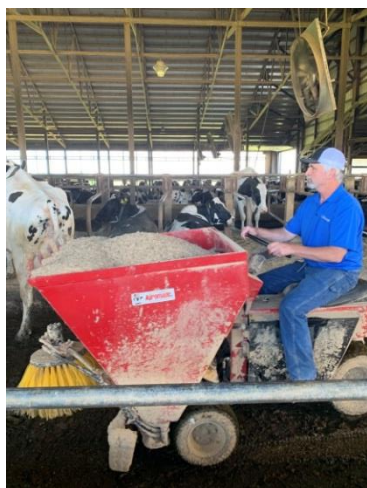
圖 25. 牧場使用木屑與石灰石粉混合作為牛床墊料
