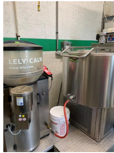
圖 14. Glamourview 牧場之仔牛自動餵飼系統結合全乳殺菌及貯存系統
