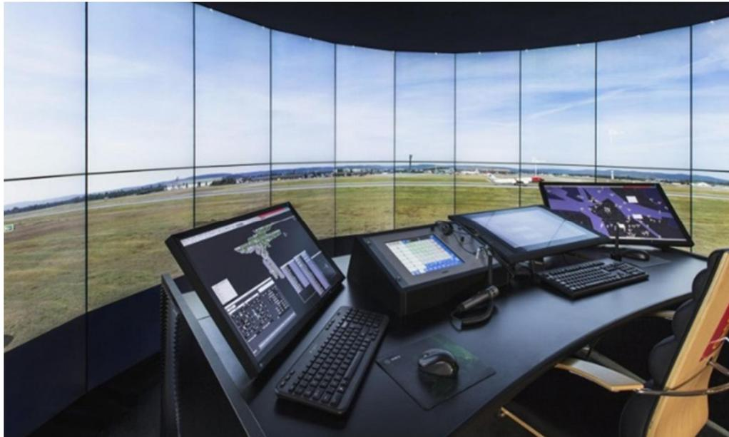
利用雷達追蹤資料結合監視器提供影像而成的遠端虛擬塔台
