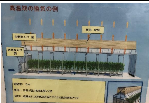
圖 5 夏季高溫期溫室換氣方式
