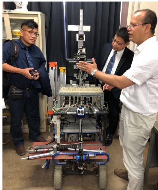
圖 28 筑波大學智慧農業團隊研發的無人農用自走車
