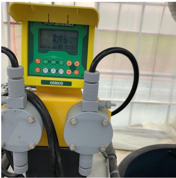
圖 9 溫室草莓肥水導電率與 pH 值之監控
