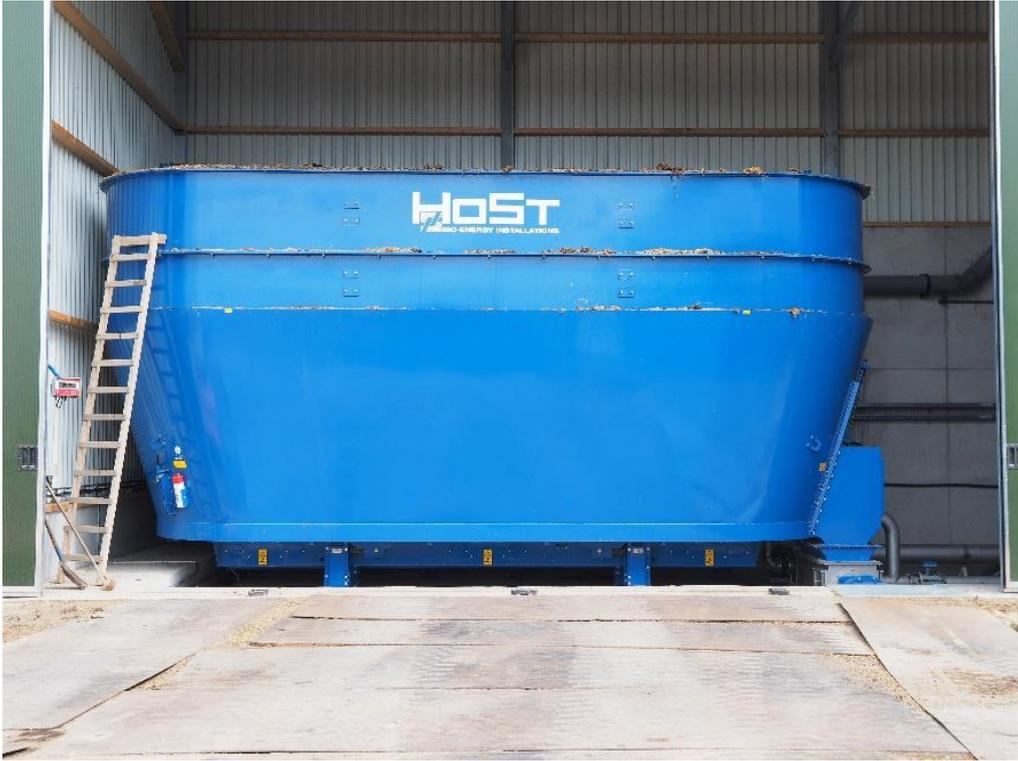
圖 19、乾牛糞與固體物進料混合槽
