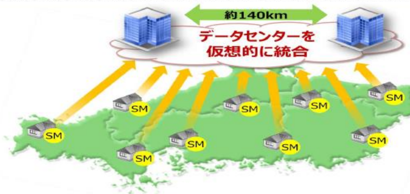
圖 81 資料中心虛擬化整合架構
