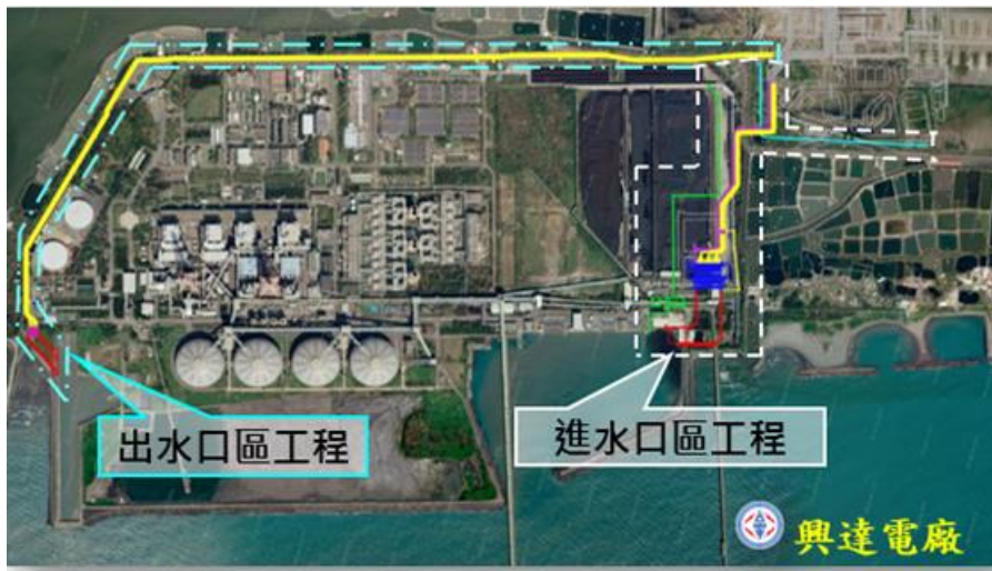
圖 71 海水進出口區及暗渠工程
