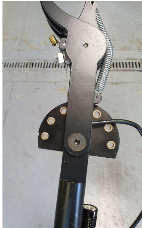
圖 42：延伸桿夾頭有多角度可調整
