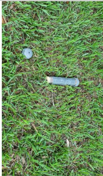
圖 25：情境設定-鋼管一端管帽已脫離，爆引（芯）外露
