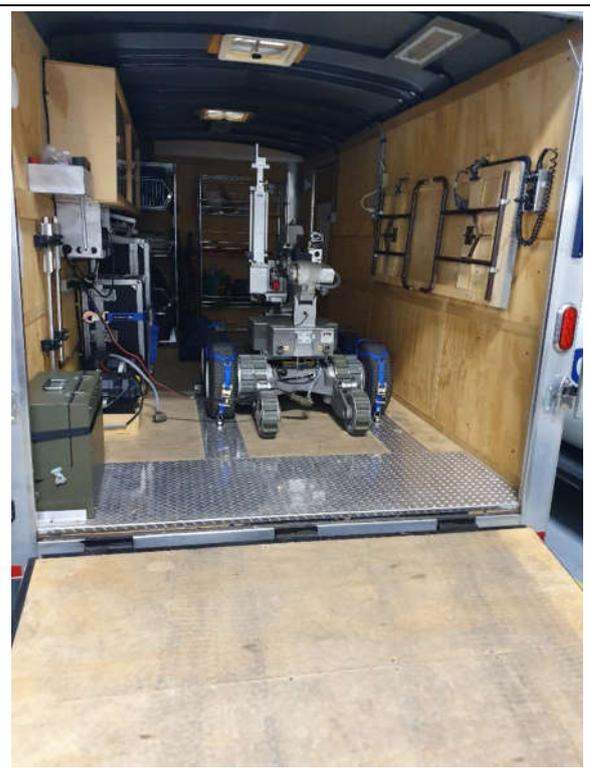
圖 48：專門載運防爆機器人之大型防爆車
