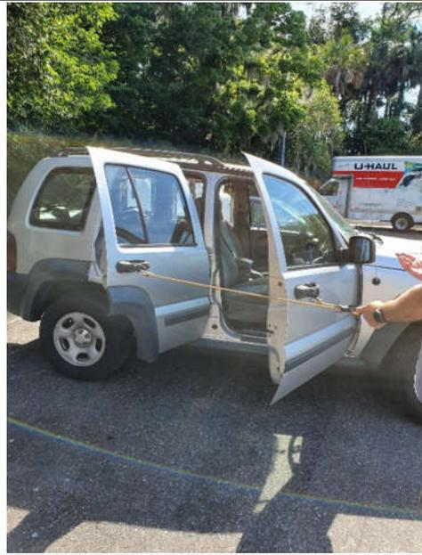
圖 32：以拖吊工具開啟車門
