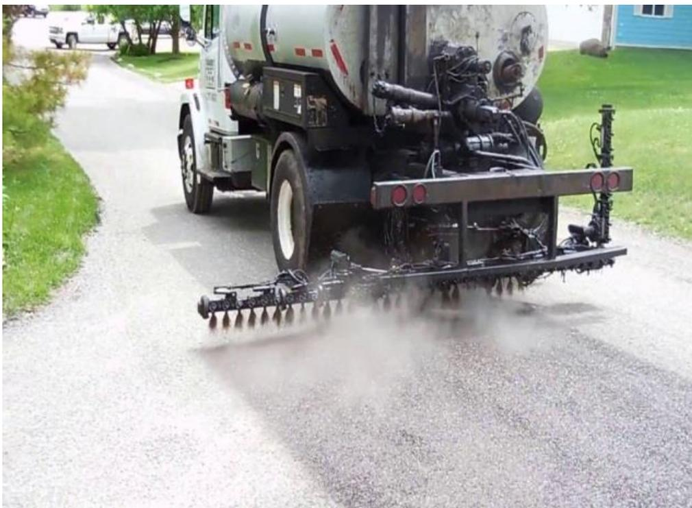
圖 3.2.2 灑布設備圖(圖資來源：PPRA 網站)
