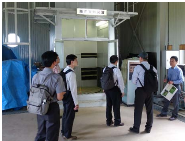
模擬降雨的裝置，用以研究雨水對農藥殘留的影響
