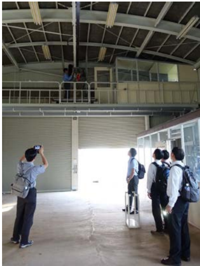
特製的無人機噴霧模擬裝置，使用時須架在高處的軌道以模擬無人機施藥情況。
