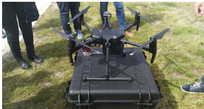
圖 32.土壤復育槽遙感探測用遙控飛機
