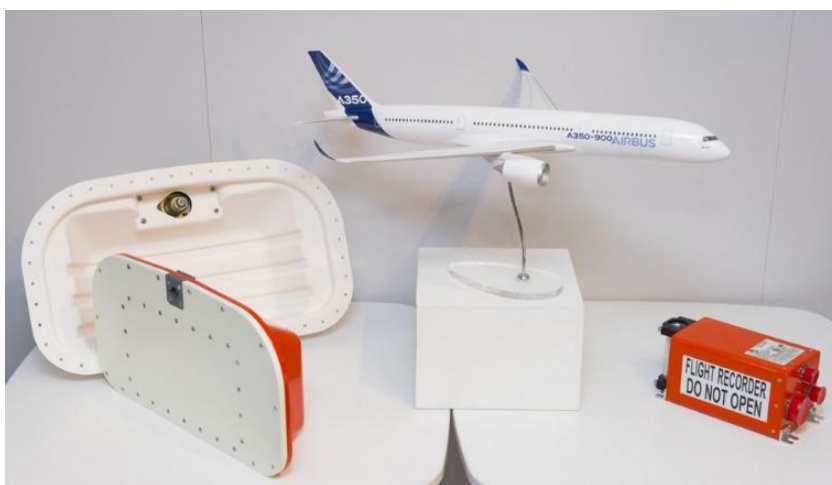
A350 自動彈射式飛航紀錄器外觀圖
