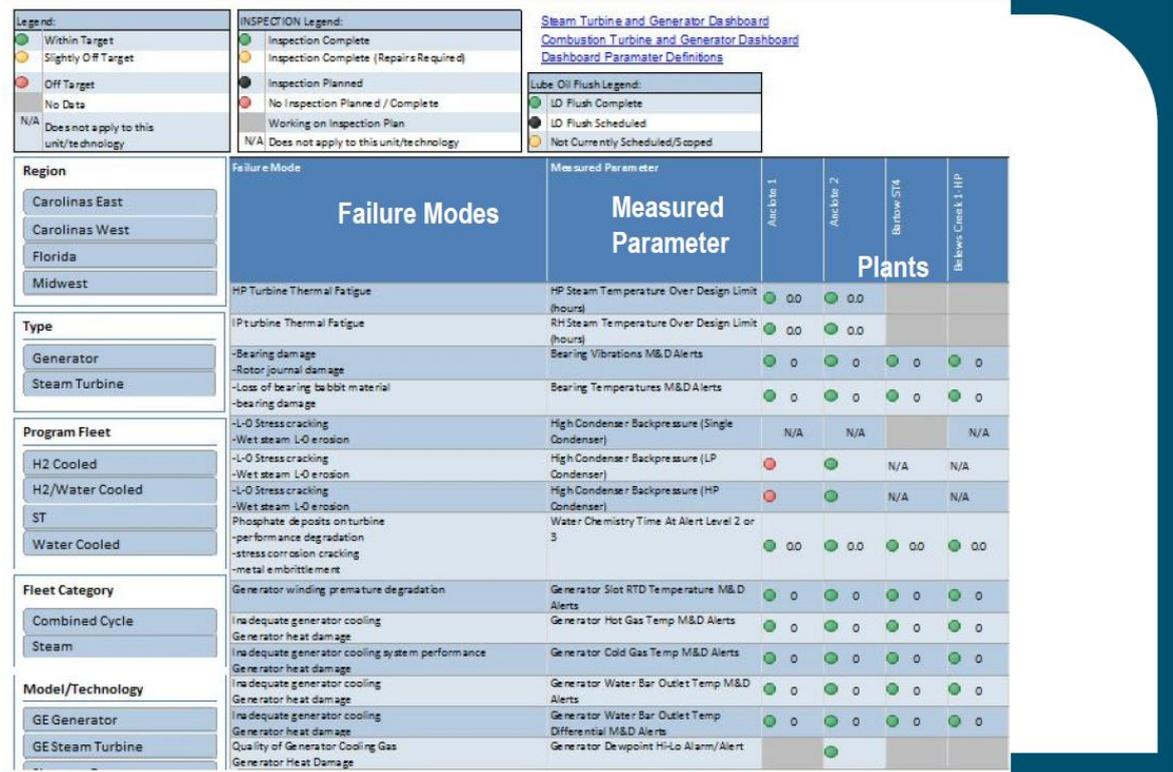
圖 9 FMEA (Failure Mode and Effect Analysis, 失效模式和效果分析) (資料來源: Duke Energy 電力公司 SmartGen 計畫簡報)
