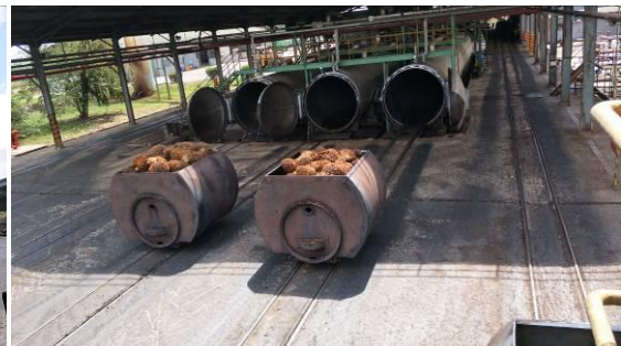
圖 66、台車開進高溫高壓槽蒸熟取果
