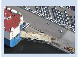
Ro/Ro cargo Direct vessel approach 用途廣泛 降低建造成本 下載貨物角度受限制
