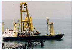
水上吊車/離岸使用(Offshore Cranes)使用限制: 承載>100 T 使用期限受限於波浪狀況 成本相對 marine cranes 提高 水深限制航道 有船身浮動影響工作性
