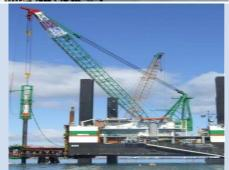
水上/揚升腳架吊車(Jacket-up barges) 使用限制: 承載>100 T,因使用 Jacket-up,故乘載 力相對提高· 使用受限於波浪狀況輕微 成本相對 offshore, marine cranes 提高 工作性相對良好,不會有船身浮動影響
