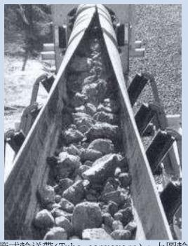
管式輸送帶(Tube conveyors),上圖輸 送礦石。
