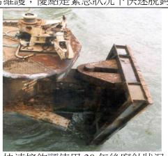
快速接鉤頭使用 20 年後腐蝕狀況
