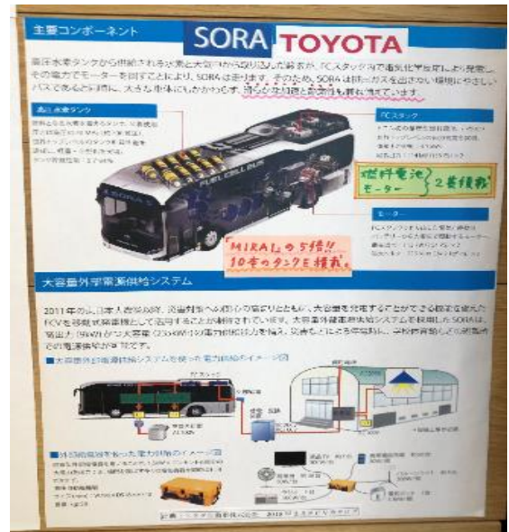
圖 20 說明氫能巴士的運作原理與氫罐放置的位置
