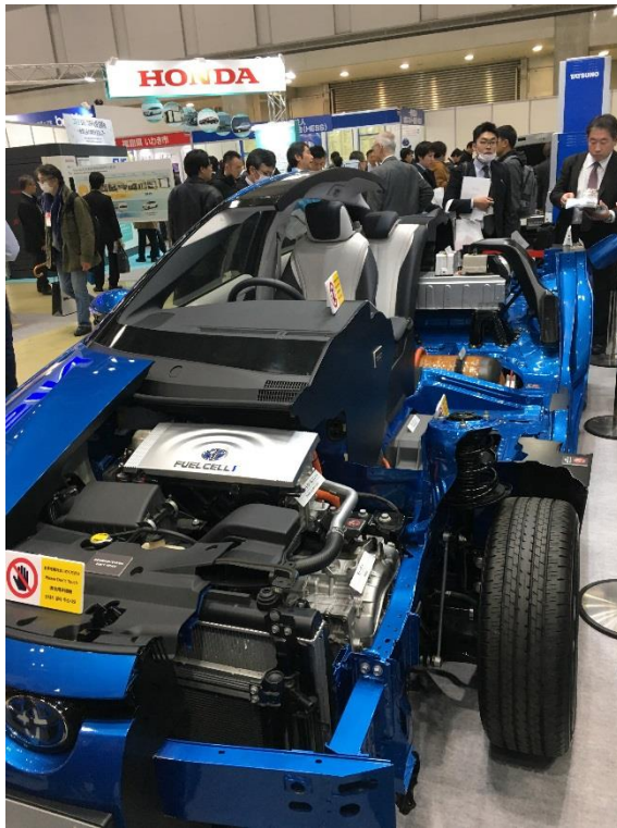
圖 15、Toyota 公司 Marai 氫燃料電池汽車結構
