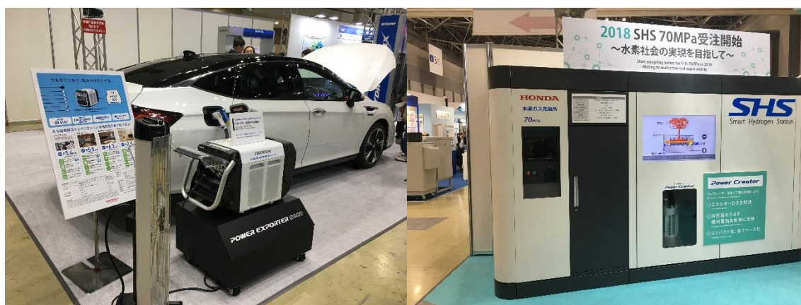
圖 17、Clarity 氫燃料電池汽車、可攜式外部電源轉換器及小型定置型加氫站(SHS)
