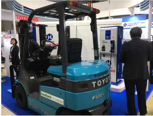
圖 19、Iwatani 公司之小型定置型產氫裝置、加氫站與燃料電池叉車
