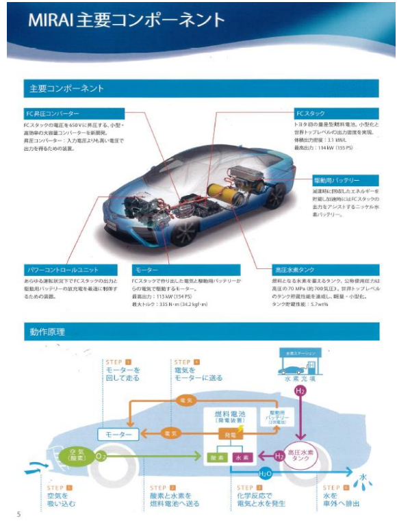
圖 15、Toyota 公司 Marai 氫燃料電池汽車結構
