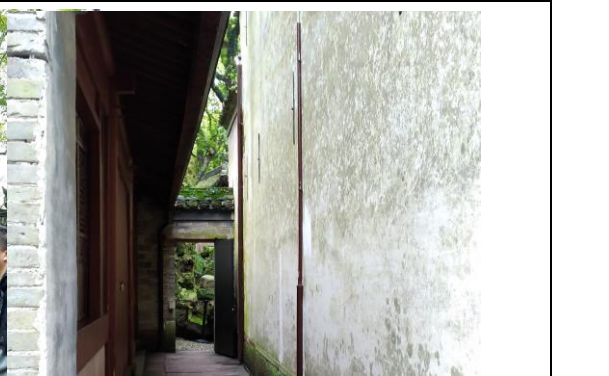
防火巷的設計，有效降低火災蔓延
