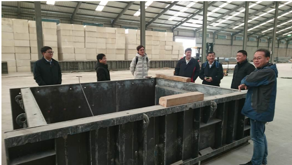
廠房浮箱模具外觀
