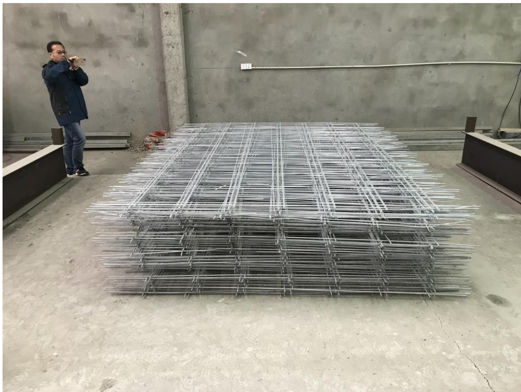
浮箱使用鍍鋅鋼筋
