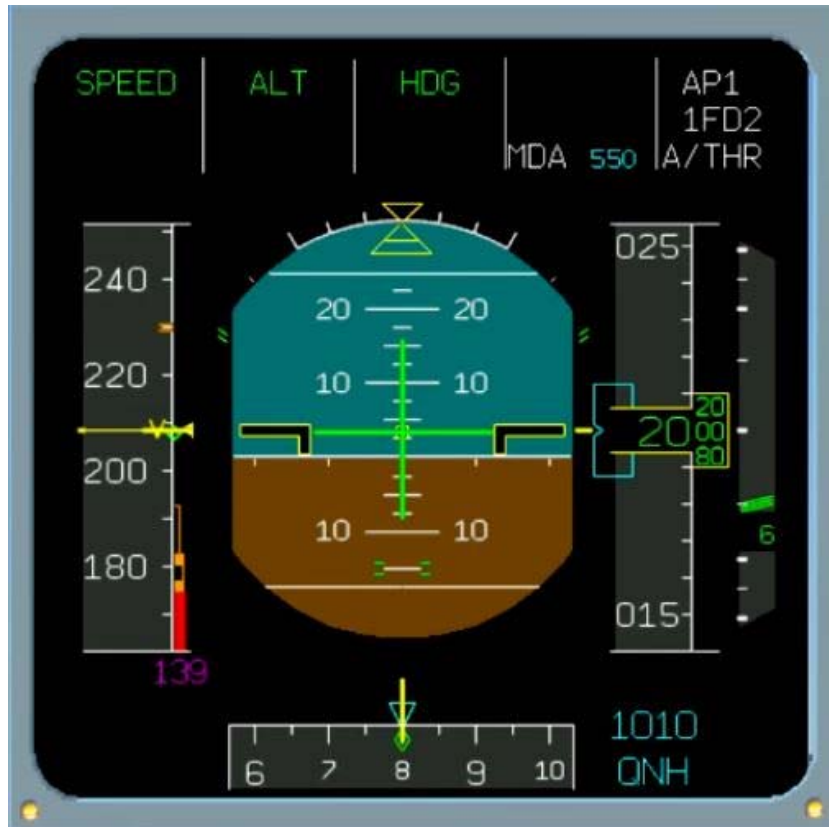
圖 3.1.2 主飛行顯示器(Primary Flight Display, PFD)
