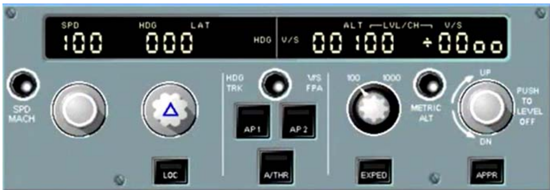
圖 3.1.9 飛航操作元件(Flight Control Unit, FCU)
