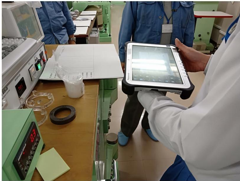
圖 10 JCAC 介紹進行加馬計測時如何以平版電腦掃描樣品 (U-8 容器) 及純鍺機臺上的條碼
