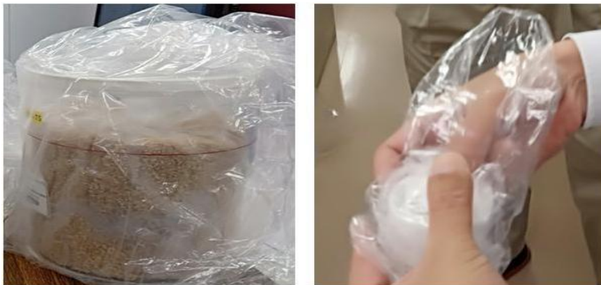
圖 7 JCAC 加馬計測容器計測前外部皆先套塑膠袋(左：馬林杯，內部樣品亦裝於塑膠袋；右 U-8 小計測皿，外部套塑膠袋示範)
