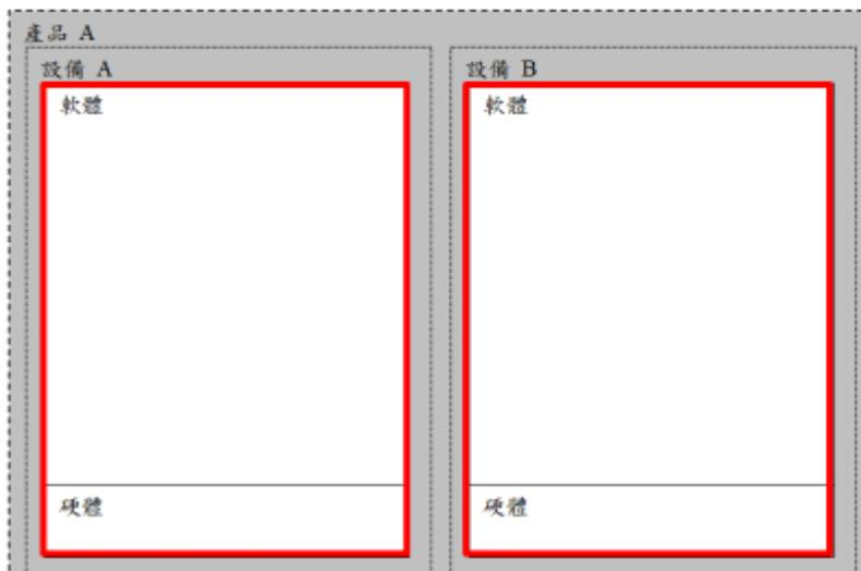
軟體/硬體整合測試在硬體內部實作所有設備軟體，並依據「定義軟體要求」之要求檢查軟體是否正常運作。
