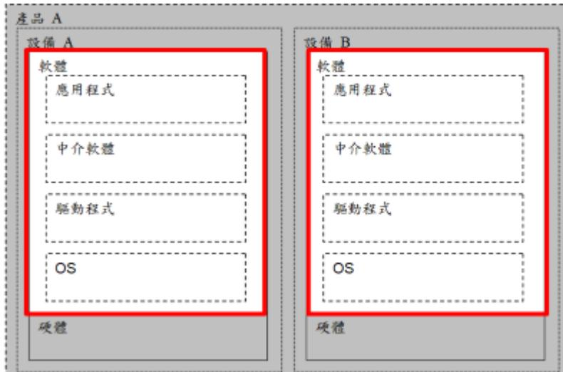
軟體整合測試是檢查軟體運作的測試，測試方法為整合軟體層區塊的部分內部區塊、整合各個區塊或整合多個軟體層區塊。
