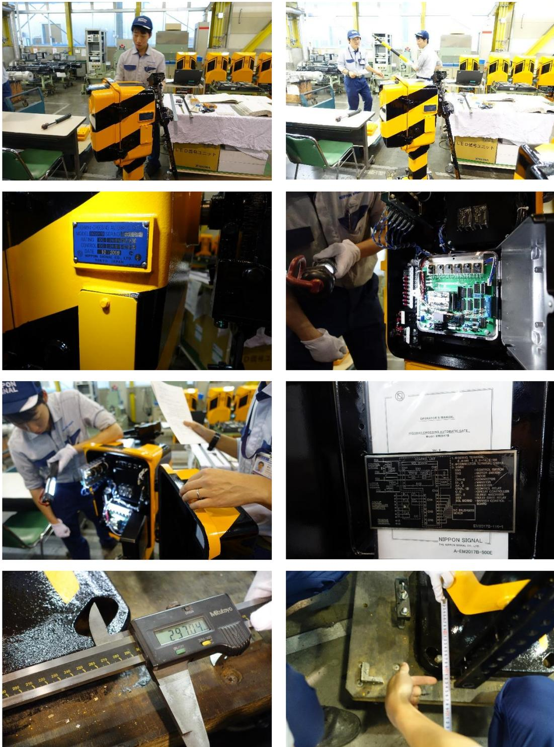
圖 3.2-3 外觀尺寸與纜線固定檢查
