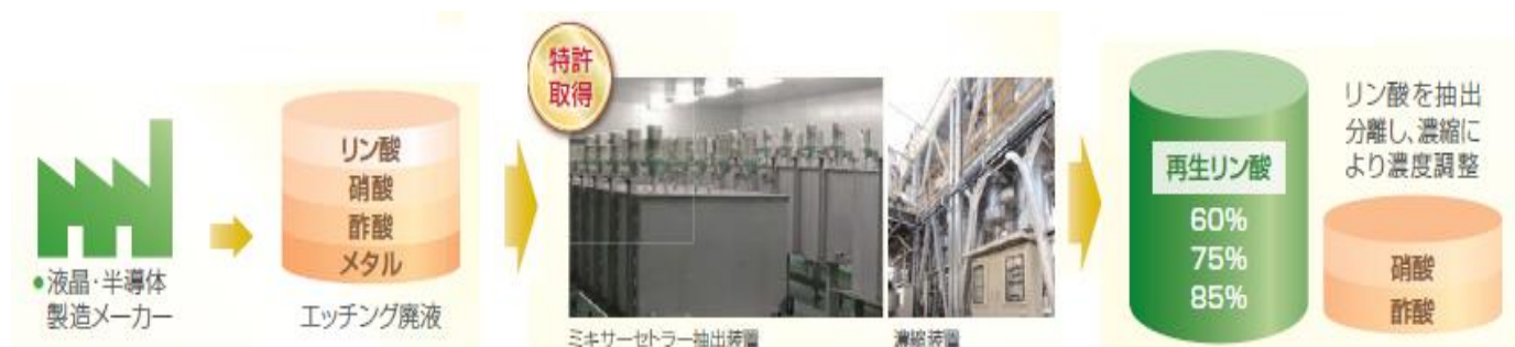
圖 5.4 三和油化工業混酸廢液處理方式
