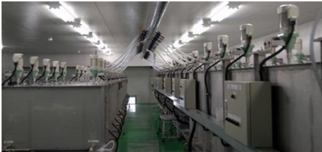
圖 5.6 多級逆向萃取回收回收磷酸裝置
