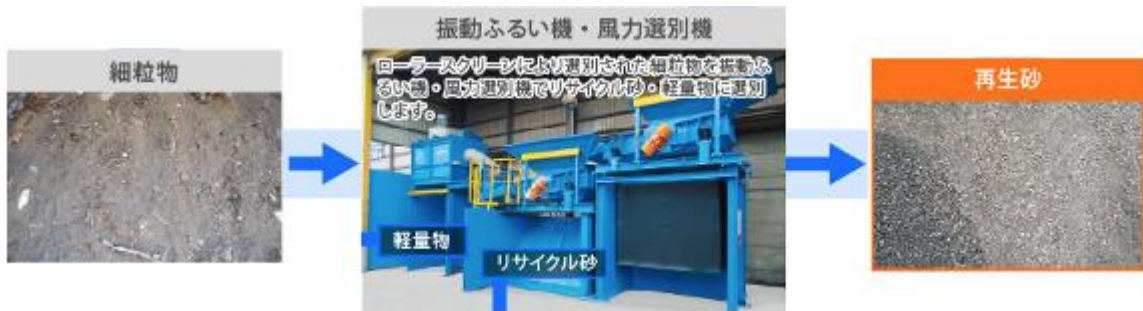
圖 3.4 細粒物製做成再生砂
