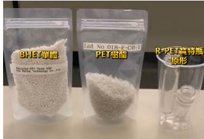
圖 2.5 製程過程各階段成品
