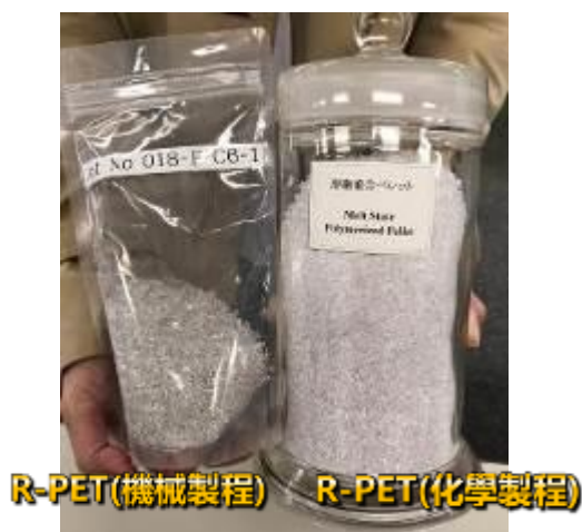
圖 2.6 機械製程及化學製程成品
