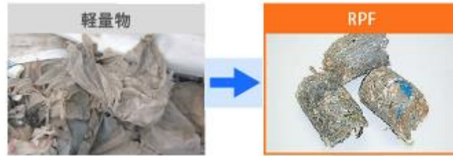
圖 3.3 輕量物製做成燃料 RPF
