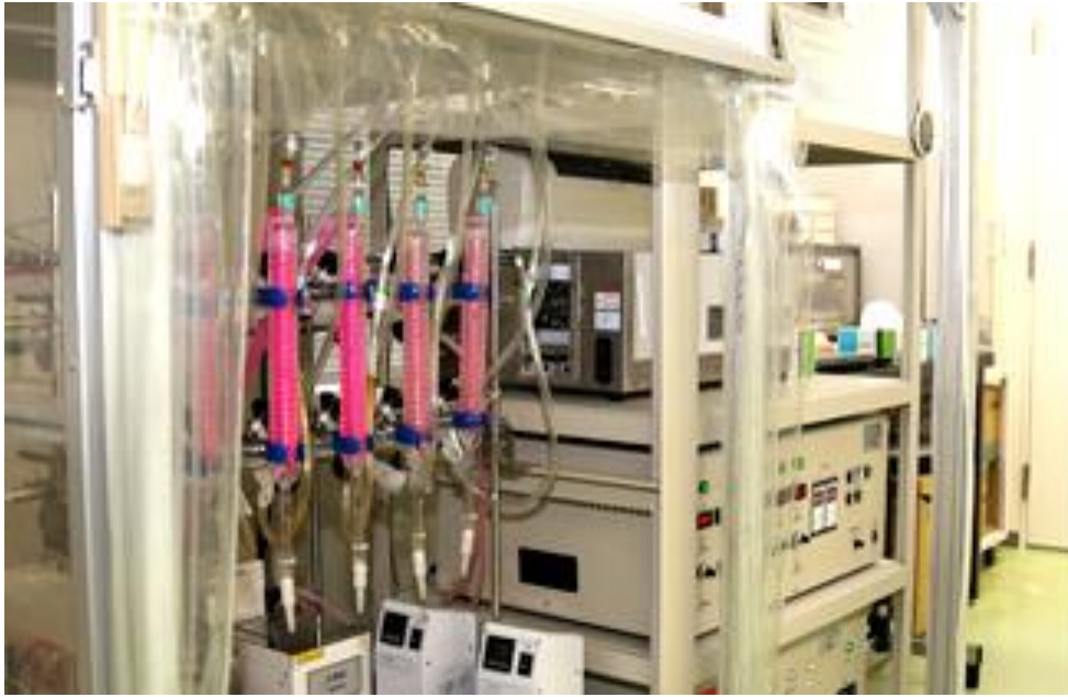
圖 III.2-6 液體吸收二氧化碳捕捉技術研究的實驗設備
