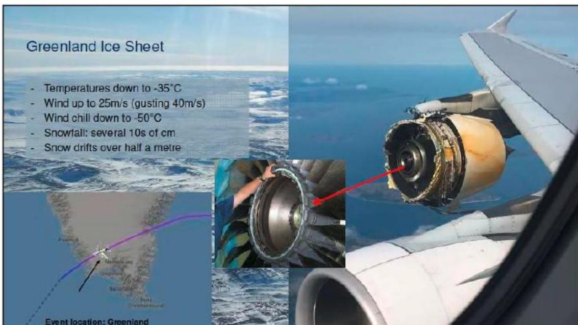
圖 3-5 巡航中發生發動機非包容性損傷情形
