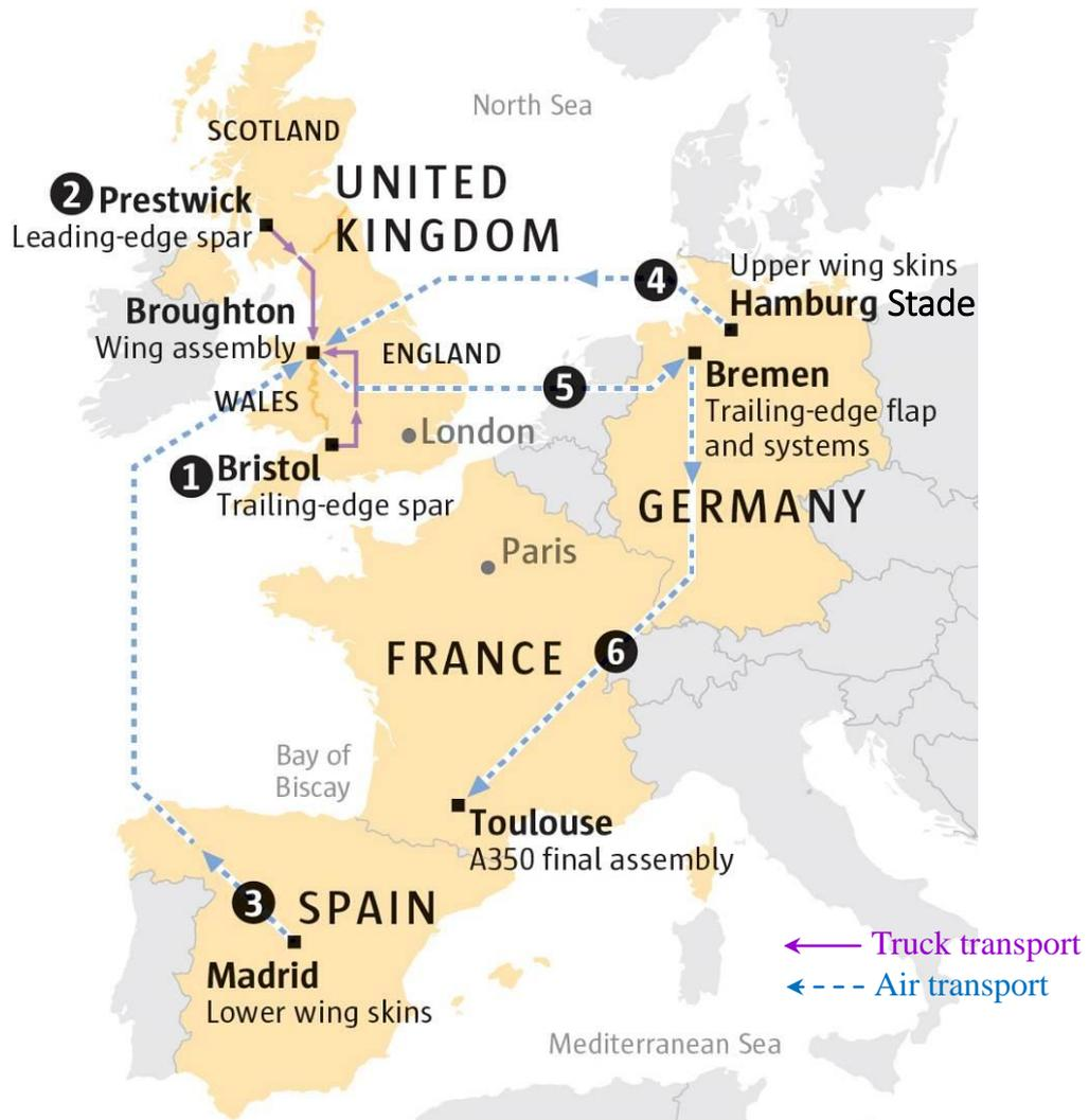
圖 3.3-1 空中巴士 A350 機翼製造流程<sup>4</sup>
