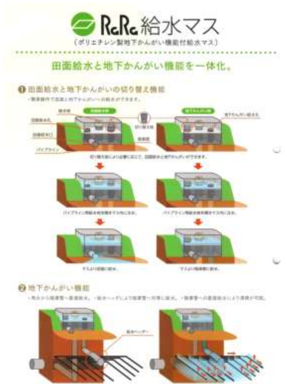
C. 水位調節設施使用介紹(給水)
