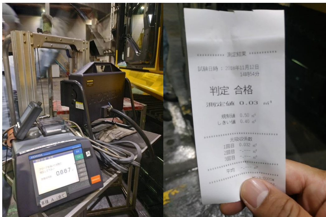
図 3 柴油引擎大型挖土機黒煙不透光率(光吸收度)排氣檢測示範
