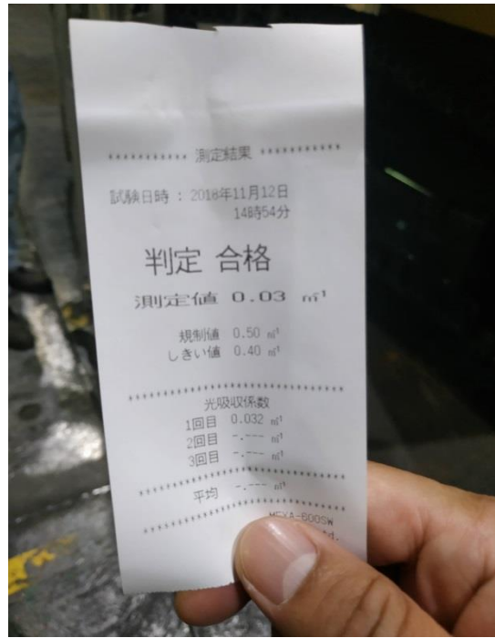
柴油引擎大型挖土機黑煙不透光率(光吸收度)排氣檢測示範
