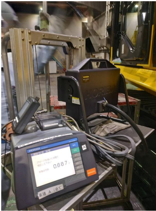
柴油引擎大型挖土機黑煙不透光率(光吸收度)排氣檢測示範
