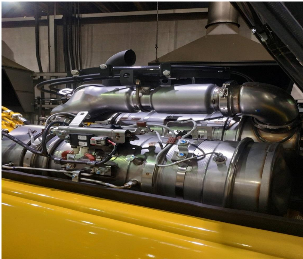
Komatsu Ltd.大型挖土機施工機具本身裝置濾煙器(標準配備)
