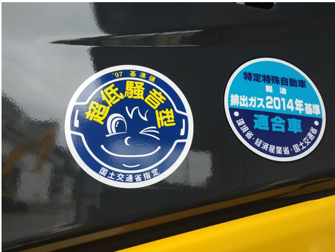
Komatsu Ltd.施工機具出廠即貼有合格標識
