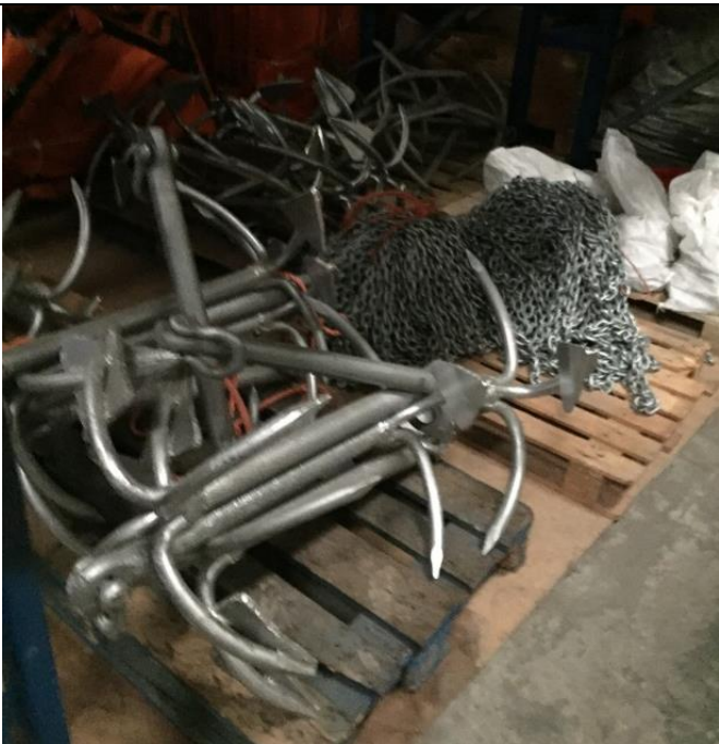
EPE 公司倉庫內錨組(固定攔油索用)
