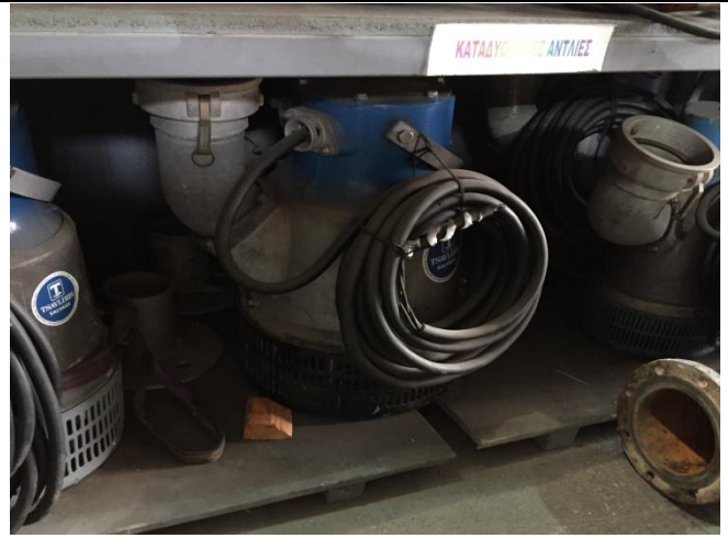
大型沉水泵浦
