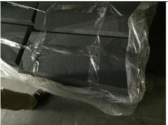
EPE 倉庫內攔油索填充泡棉
