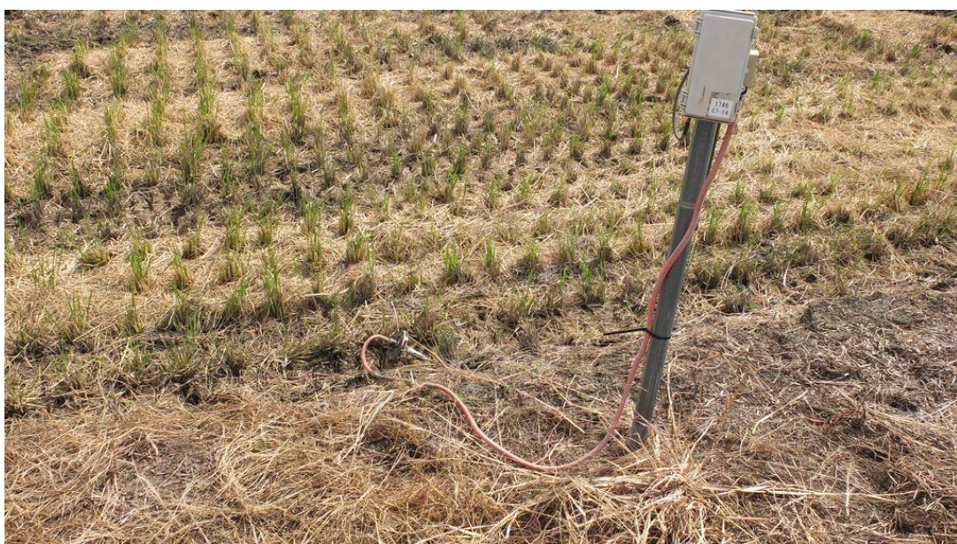
圖 6、積水化學水位監控系統
