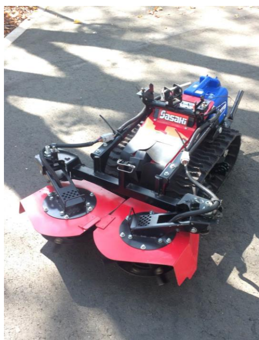
圖 10、農研機構研發之自動除草機
