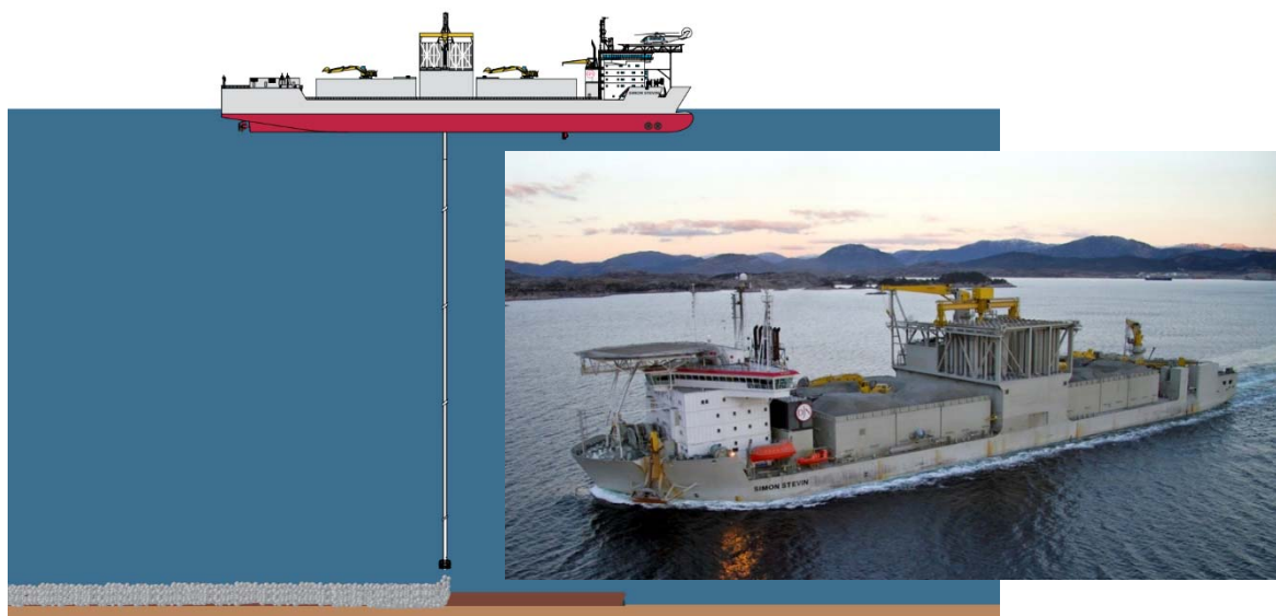
JDN施作防淘刷保護工的船隻SIMON STEVIN (可承載31,500噸的拋石，處理深度高達2000公尺)
