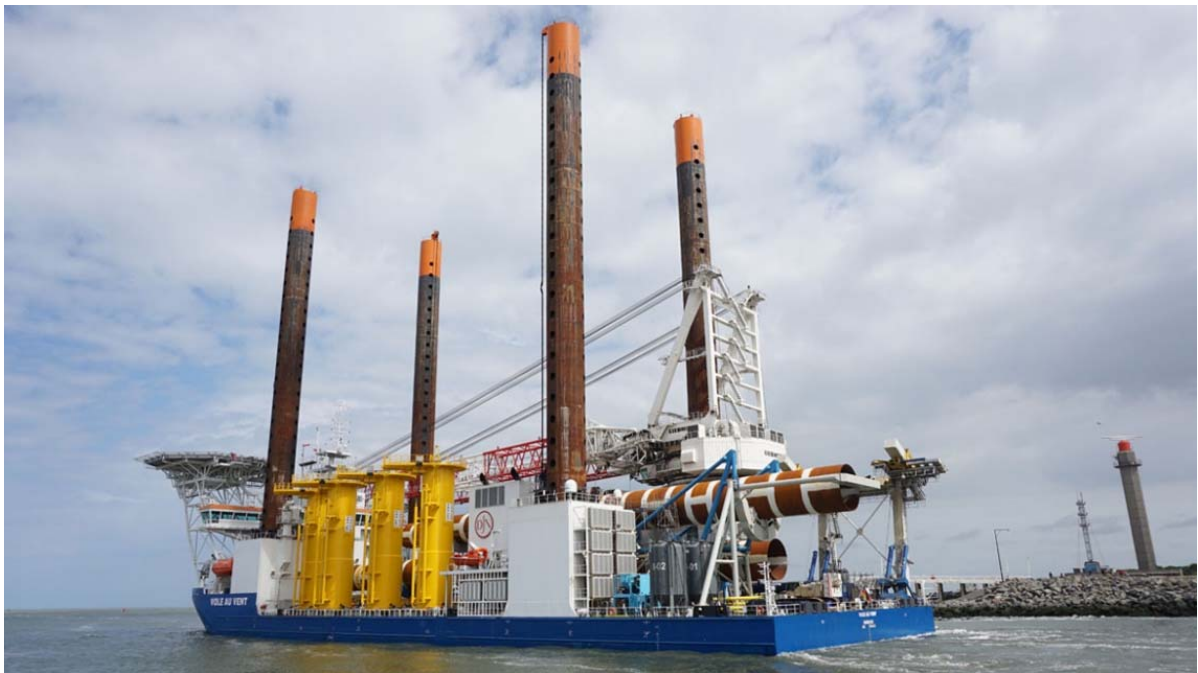
Vole au vent每趟可裝載4個單樁與4個連接段 (圖片取自REBO網站)
