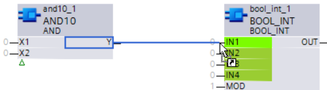
圖 4-17 CFC 模塊連接圖
