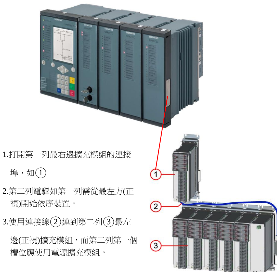
圖 4-6 第二列擴充模組連接方式示意圖
