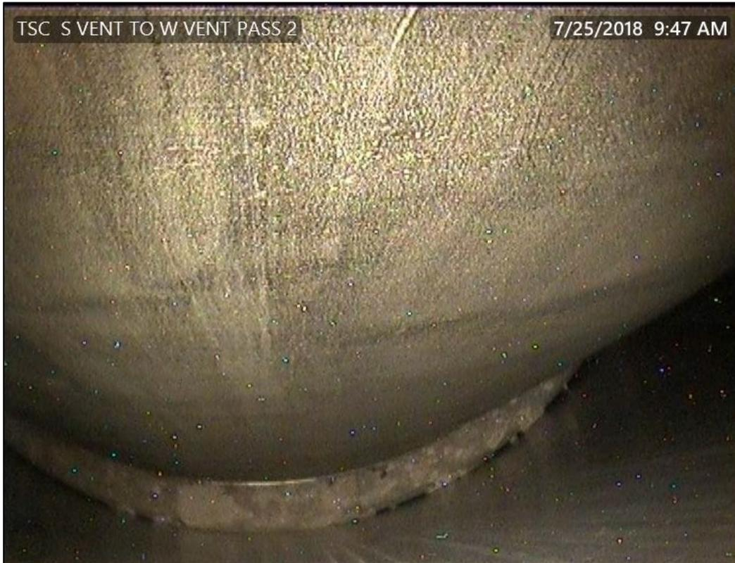
圖2-3-2-6-5錄影設備在通風道所看到的密封鋼筒
