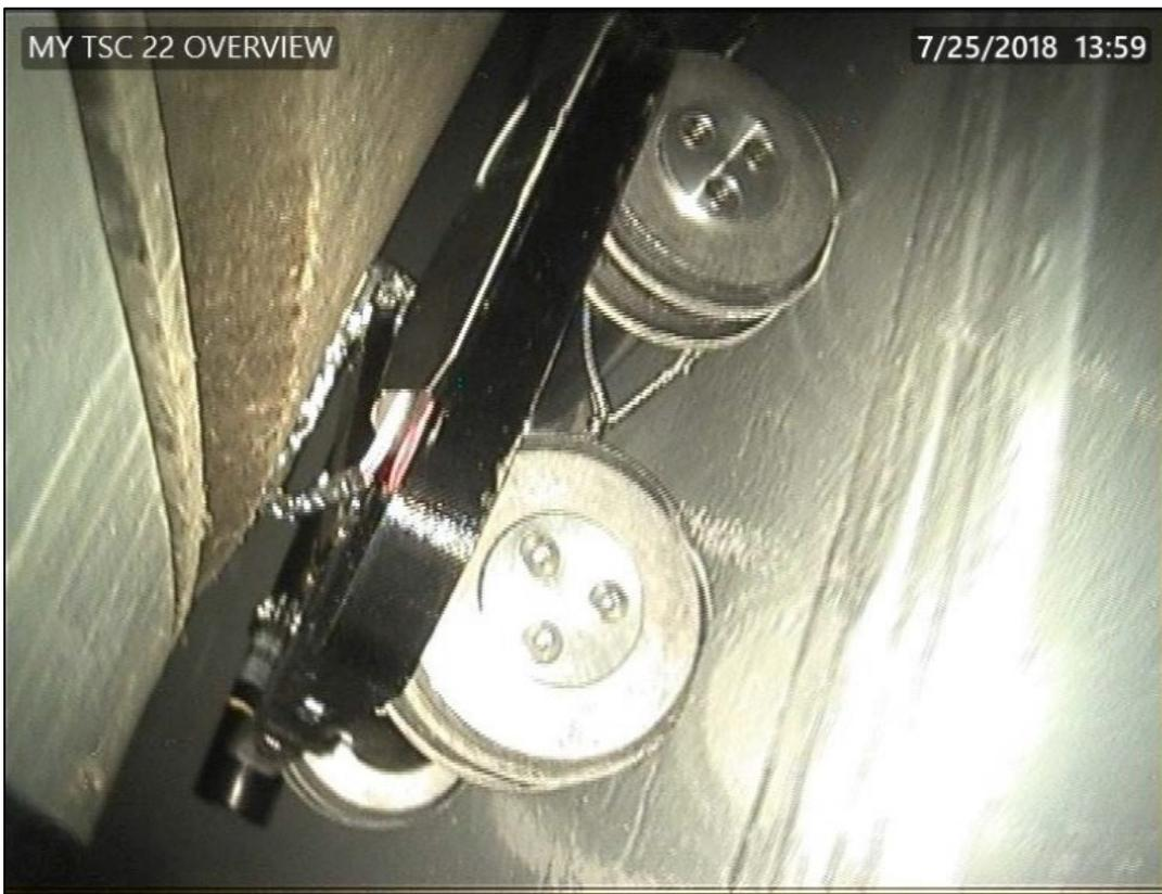
圖2-3-2-6-4載具及檢測設備進入通風道
