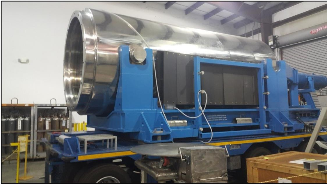
圖2-2-1-6專用運輸車上的水平運送護箱
